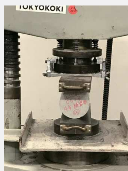
割裂引張試験
